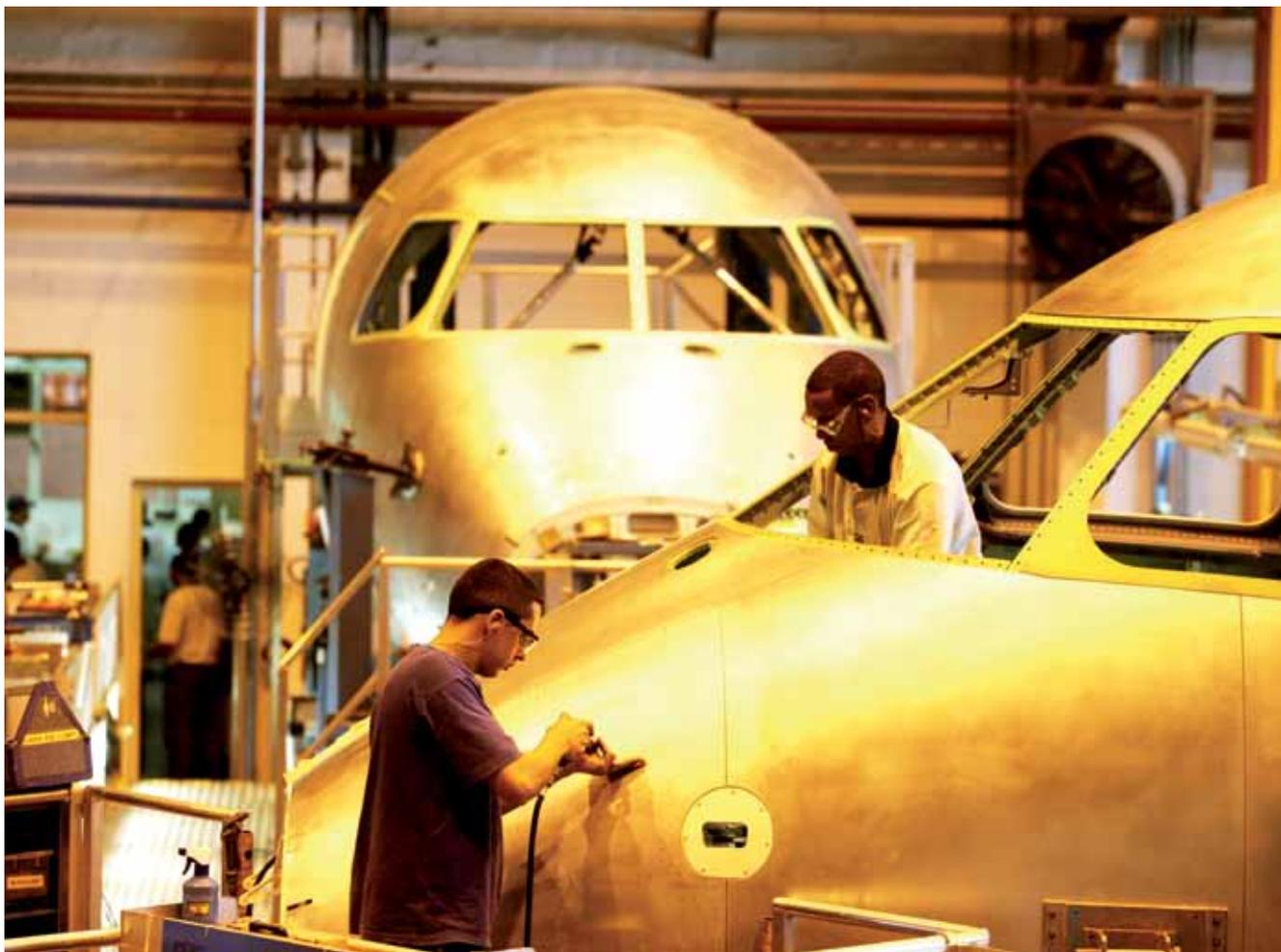
1. Projeto *Conforto de Cabine* simula modelos da Embraer para testar temperatura, pressão, ruído, vibração, iluminação, ergonomia e odores
